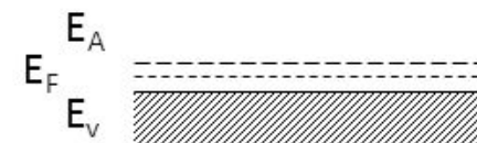
Rys. Schemat ułożenia pasm energetycznych w półprzewodniku akceptorowym w temperaturze 0K: E_A – energia poziomu akceptorowego.
